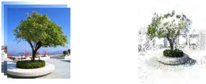
Abbildung 20 (links) Ursprungsfotos, (rechts) erzeugte Punktwolke [ITM07]
