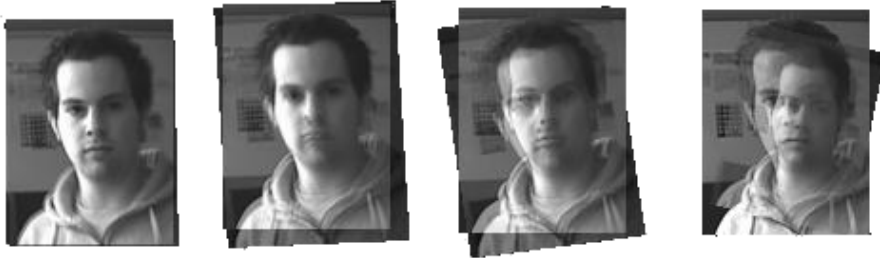
Abbildung 14: Künstlicher Fehler: Durchschnittsbild des Referenz- und registrierten Objektbildes, in das nachträglich von links nach rechts folgende Fehler eingerechnet wurden: w = 0; 0.3; 0.6; 0.9
