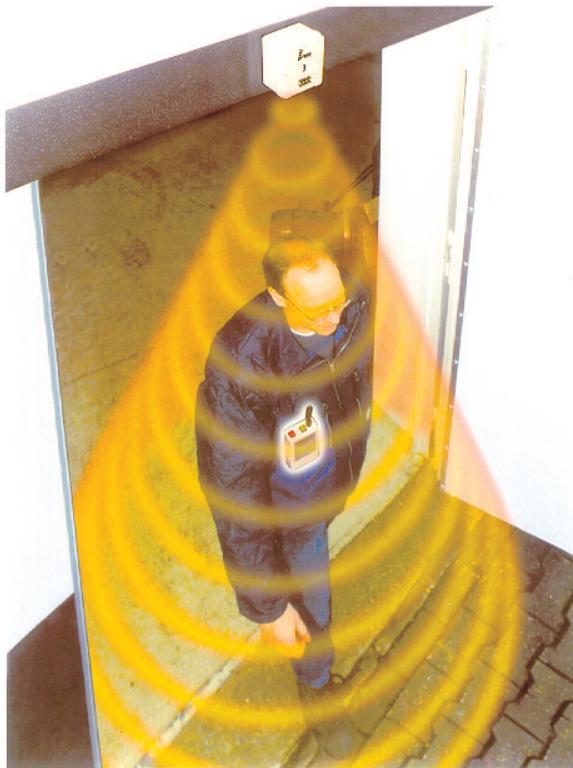
Bild 2: Beispiel für die Erfassung des Alleinarbeiters durch Ortskennungssender
