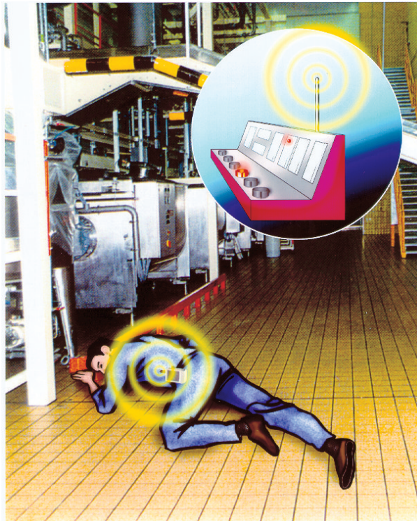
Bild 1: Schema einer Personen-Notsignal-Anlage
