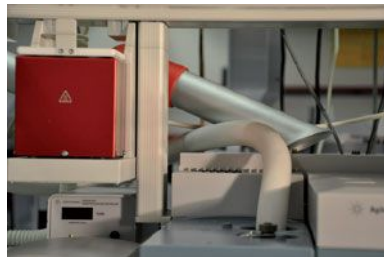
Abbildung 6: Quellenabsaugung an einem Gaschromatographen mit einem beliebig positionierbaren Rohr mit Gelenken.
