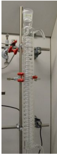
Abbildung 12: Beispiel für einen Produktkühler: im Schlangenkühler (Graham condenser) blockiert aufsteigender Dampf das zurückfließende Kondensat und drückt dieses heraus.
