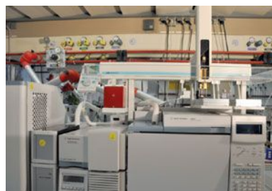
Abbildung 22: Beispiel für eine örtliche Absaugung an einem Gaschromatographen
