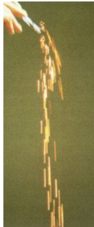
Abbildung 8: Pyrophores Eisen beim Ausschütten aus einer Schutzgas-Ampulle
