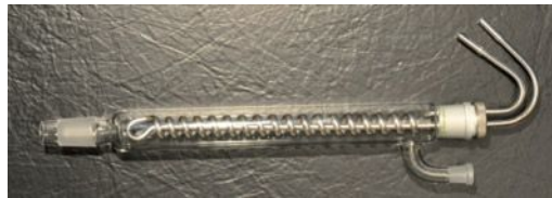
Abbildung 13: Kühler mit eingesetzter Metallkühlschlange.
