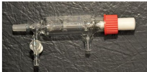
Abbildung 17: Überdruckventil für Glasapparaturen
