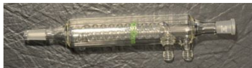
Abbildung 10: Kühler mit Glasgewinden für den Kühlwasseranschluss.
