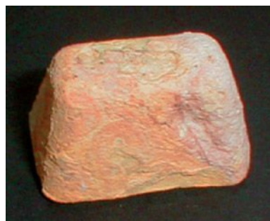
Abbildung 9: Stark oxidiertes Stück Kalium (21)
