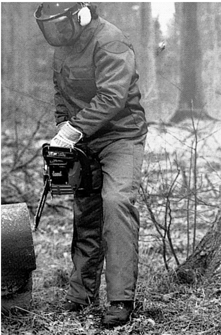
Abb. 15: Beispiel einer Schnittschutzhose nach DIN EN 381-5
