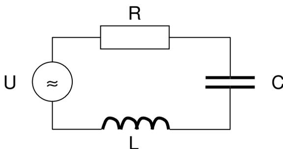
Nach dem Kirchhoffschen Gesetz ist die Summe der Spannungsabfälle am Widerstand R, Kondensator C und an der Spule L gleich der Spannung U an der Spannungsquelle
