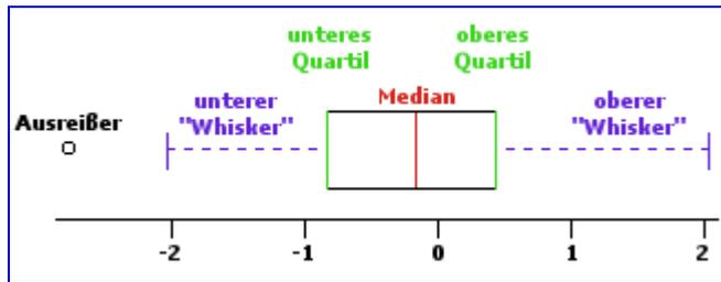
Der Boxplot ist eine kompakte Methode, die wesentlichen Parameter einer Datenreihe in einem Bild zu visualisieren:
