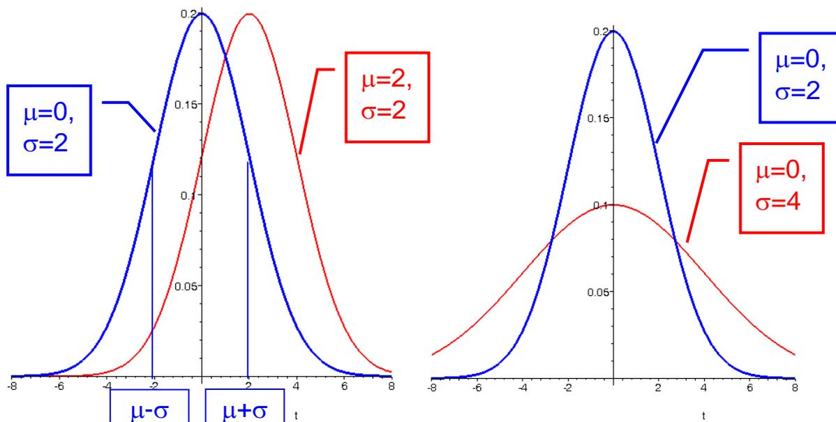
Die Parameter  $\mu$  und  $\sigma$  lassen sich auch unmittelbar aus der grafischen Darstellung der Dichtefunktion ablesen: Die Gauss'sche Glockenkurve hat ihr Maximum bei  $t=\mu$  und ihre Wendepunkte bei  $\mu-\sigma$  und  $\mu+\sigma$ .
