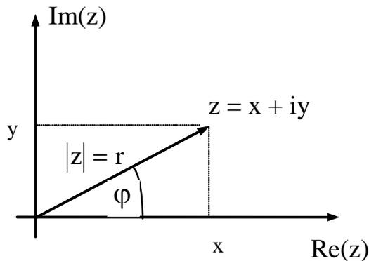
In Analogie zu den Polarkoordinaten kann die komplexe Zahl  $z = x + iy$  auch durch die Länge des Pfeils und einen Winkel dargestellt werden. Mit Hilfe der Transformationsgleichungen:
