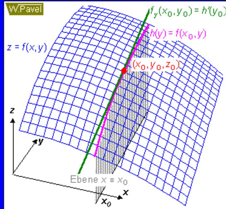
Partielle Ableitung nach  $y$  der Funktion  $z = f(x, y)$
