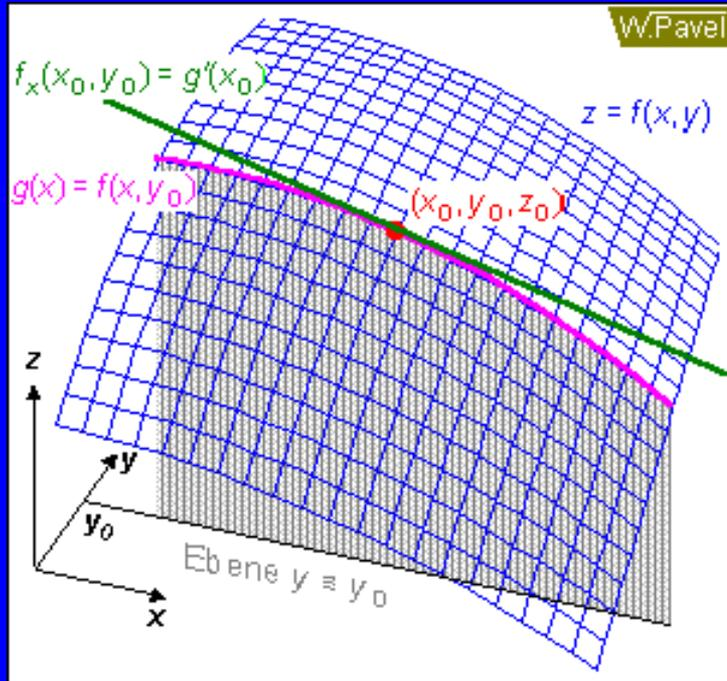
Partielle Ableitung nach  $x$  der Funktion  $z = f(x, y)$
