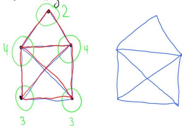
Def: Eulerzug : Jede Kante des Graphen wird genau einmal durchlaufen (Brückenproblem!)
